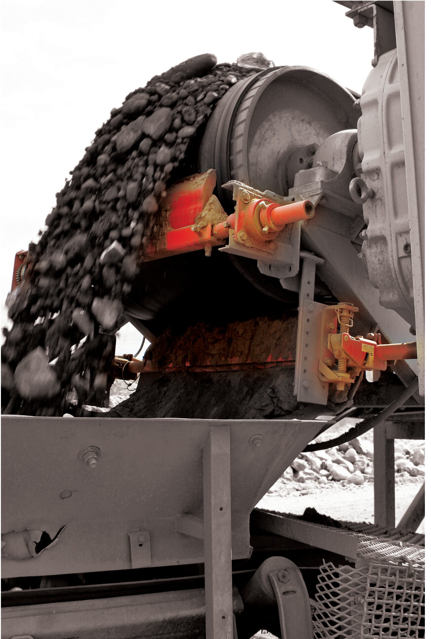
▲ Martin Bant Sıyırıcıları, ham cevher veya işlenmiş konsantre taşıyan konveyörlerden geri taşınan malzemeyi temizler.
