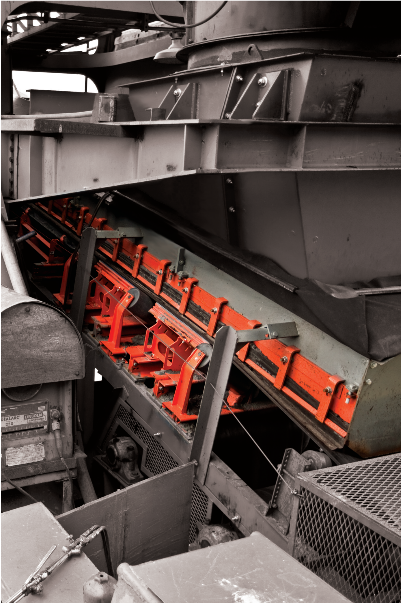
▲ Martin Transfer Noktası Ürünleri, konveyör bandını hizada tutarken, bant hattını dengeler ve döküntüyü önler.
